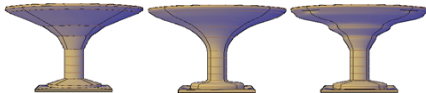
objetos solevados con distintos parámetros de sección transversal
