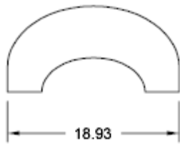
texto centrado verticalmente en la línea de cota
